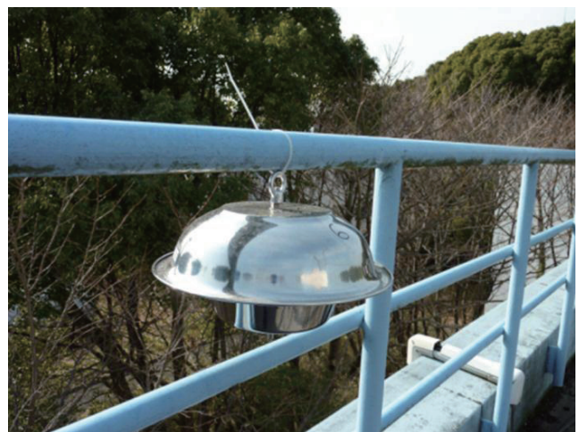
図2 パッシブ大気サンプラーの設置状況
